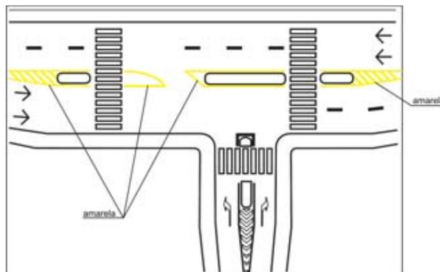
CANTEIRO CENTRAL FORMADO COM MARCAS DE CANALIZAÇÃO COM CONVERSÃO À ESQUERDA
