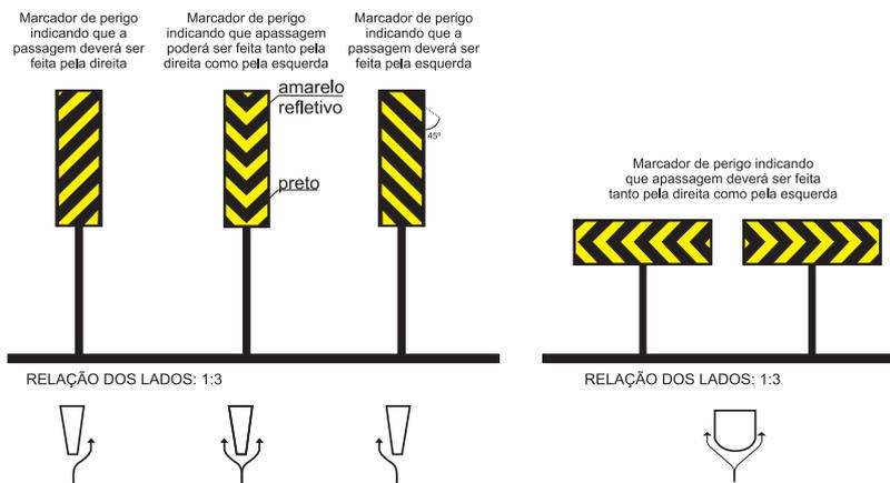
• **Marcadores de Alinhamento** – unidades refletivas fixadas em suporte, destinadas a alertar o condutor do veículo quando houver alteração do alinhamento horizontal da via.
