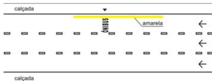
MARCA DELIMITADORA PARA PARADA DE ÔNIBUS EM FAIXA DE ESTACIONAMENTO
