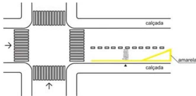
**c) Marca Delimitadora de Estacionamento Regulamentado**
